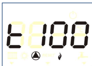
Prevádzka v režime „Kominár“ s maximálnym výkonom
